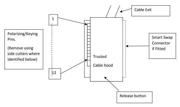
**Figure 4 Module Polarisation**
